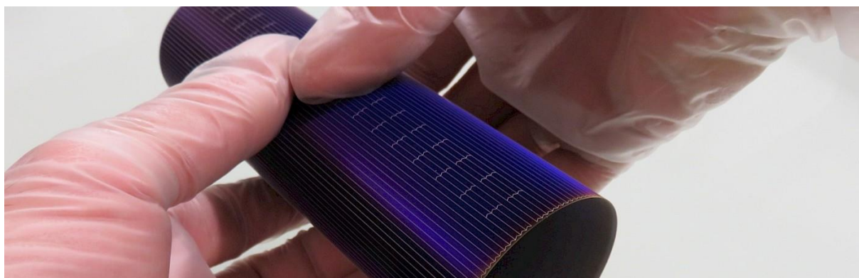
Figure 1 : Cellule à hétérojonction de silicium ultra-mince (65µm) fabriquée au CEA à l'INES
