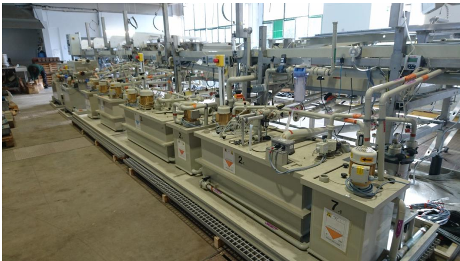
Plate-forme SOLCIS : ligne pilote pour l'électrodépôt de panneaux CIGS 60x120 cm 2 .
